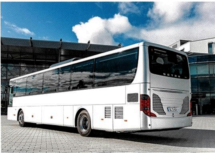
Links: Die Lüftergitter in der Heckklappe weisen auf den Euro-6-Motor hin. Rechts: Das UL-Cockpit stammt aus der MultiClass 400.
